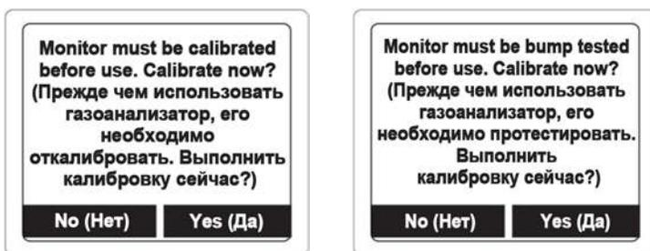
Если выбран параметр Can't Bypass (Нельзя пропустить), дисплей выглядит, как показано ниже, при этом позволяет только выполнить тест или выключить устройство:
