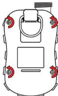
5. Придерживая газоанализатор ToxiRAE Pro CO<sub>2</sub>, отсоедините заднюю крышку: потяните за верхнюю часть крышки и поднимите ее, не отключая ленточный соединительный кабель.
